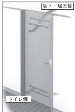
<通気・音配慮>トイレドアの概要図
