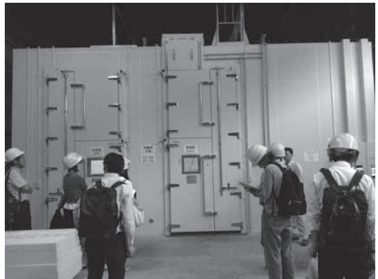
写真6 断熱性能評価試験設備
