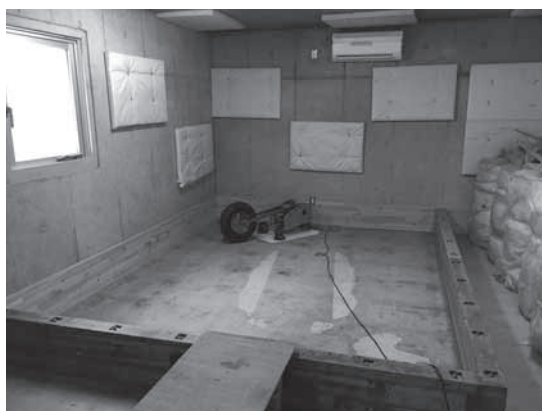
写真2 床衝撃音実大実験室(音源側)
