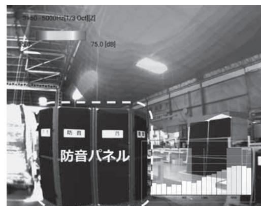
図8-2 可視化結果(防音パネル設置後)
