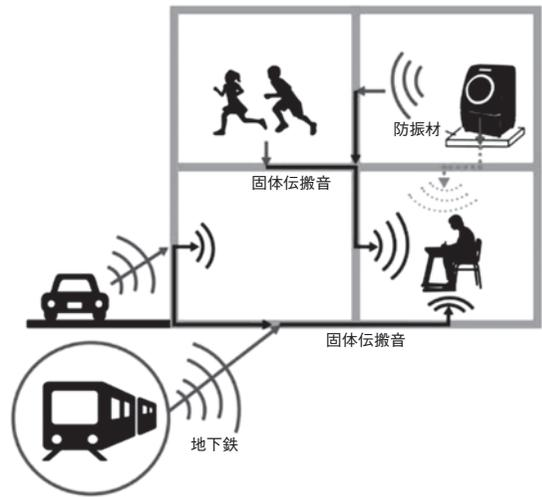
図8 固体伝搬音と防振
