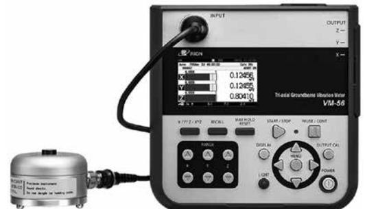
写真2 Tri-axial Groundborne Vibration Meter VM-56
