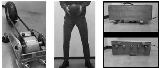
左図: バングマシン, 中央図: ゴムボール 右図: タッピングマシン
