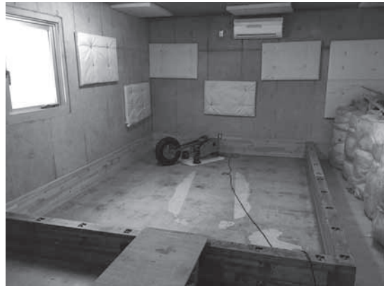
写真2 床衝撃音実大実験室(音源側)
