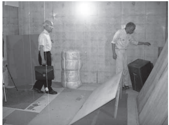
写真3 床衝撃音実大実験室(受音側)
