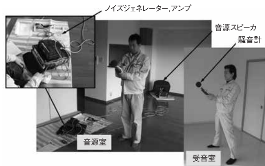
図9 室間音圧レベル差測定の測定風景
